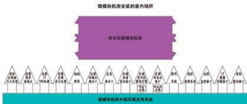
图 8 微模块机房放置场所与外部环境支持系统示意图
